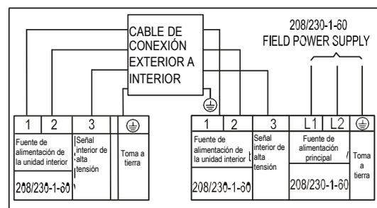
Diagrama de conexión (208/230 V)
