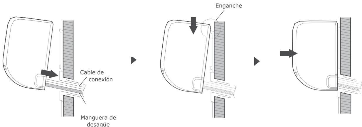
Coloque los tubos en el orificio de la pared
