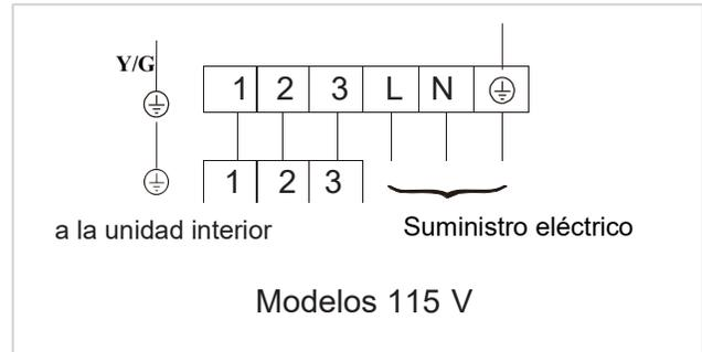
El bloque de terminales de la unidad exterior está protegido por la tapa del cableado eléctrico, al costado de la unidad. En el interior de la tapa del cableado eléctrico hay un esquema detallado de la instalación eléctrica.
