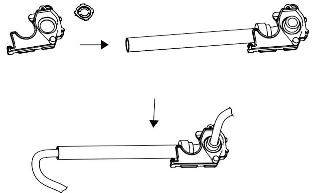
En primer lugar, retire el panel prepunzado para crear una ranura por la que pueda instalarse el conducto. Pase el cable por el conducto y luego conéctelo a la unidad interior.
