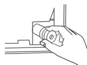
A fin de evitar filtraciones indeseadas, tape el agujero de desagüe que no se utilizará con el tapón de goma que viene con la unidad.
