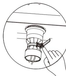
2. Après l'installation ou l'entretien, l'attache ou l'anneau en caoutchouc doit être serré, ne pas desserrer ni jeter; le panneau d'accès du boîtier de commande doit être installé et les vis doivent être serrées.
