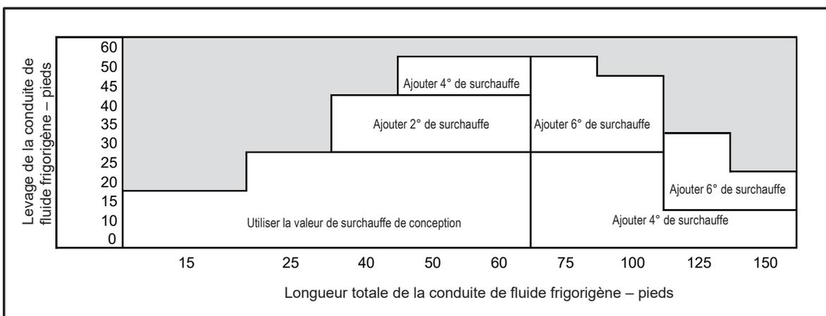
5. Utiliser la valeur finale de surchauffe, la température et la pression du fluide frigorigène de l'ÉTAPE 4 pour déterminer la pression appropriée du manomètre d'aspiration à l'aide du tableau 14-1.
