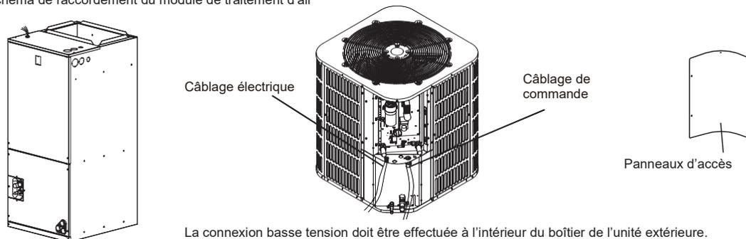
La connexion basse tension doit être effectuée à l'intérieur du boîtier de l'unité extérieure.
