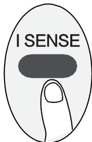
Lorsque la fonction I SENSE est activée, la télécommande affiche la température réelle à son emplacement. La télécommande envoie ce signal au climatiseur toutes les 3 minutes d'intervalles jusqu'à ce que vous appuyiez de nouveau sur la touche I SENSE.
